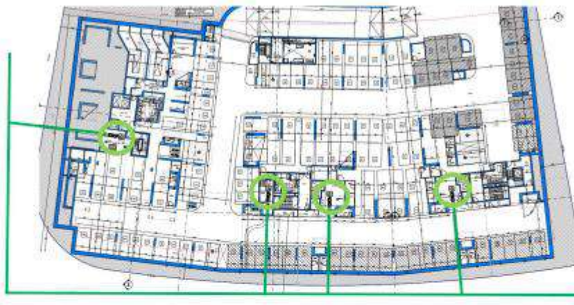
תכנון לדוגמה לצנרת פנאומטית במגרש הפרטי – כניסה ישרה וקצרה לחדר המגופים
